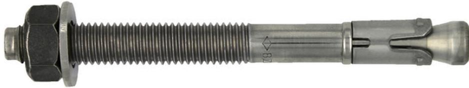
Der Bolzenanker BZ plus A4 (ETA, Option 1) vereint hohe zulässige Lasten mit geringen Rand- und Achsabständen. Der Spreizkonus ist mit einer dauerhaften, hitzebeständigen Gleitbeschichtung versehen, die den direkten Kontakt von Konus und Spreizhülse verhindert. Dies sichert bei Rissbildung im Beton das notwendige Nabspreizen
