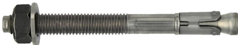
Der Bolzenanker BZ plus A4 (ETA, Option 1) vereint hohe zulässige Lasten mit geringen Rand- und Achsabständen. Der Spreizkonus ist mit einer dauerhaften, hitzebeständigen Gleitbeschichtung versehen, die den direkten Kontakt von Konus und Spreizhülsen verhindert. Dies sichert bei Rissbildung im Beton das notwendige Nabspreizen
